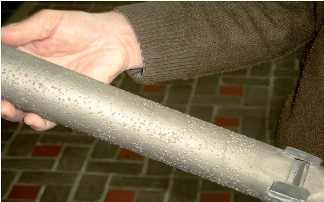
Koewacht, RK kerk, pijpwerk oxidatie
